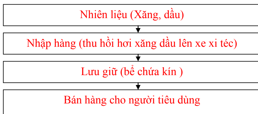
Hình 3. Sơ đồ quy trình nhập, tồn chứa, xuất bán xăng dầu của Petrolimex– Cửa hàng 102
